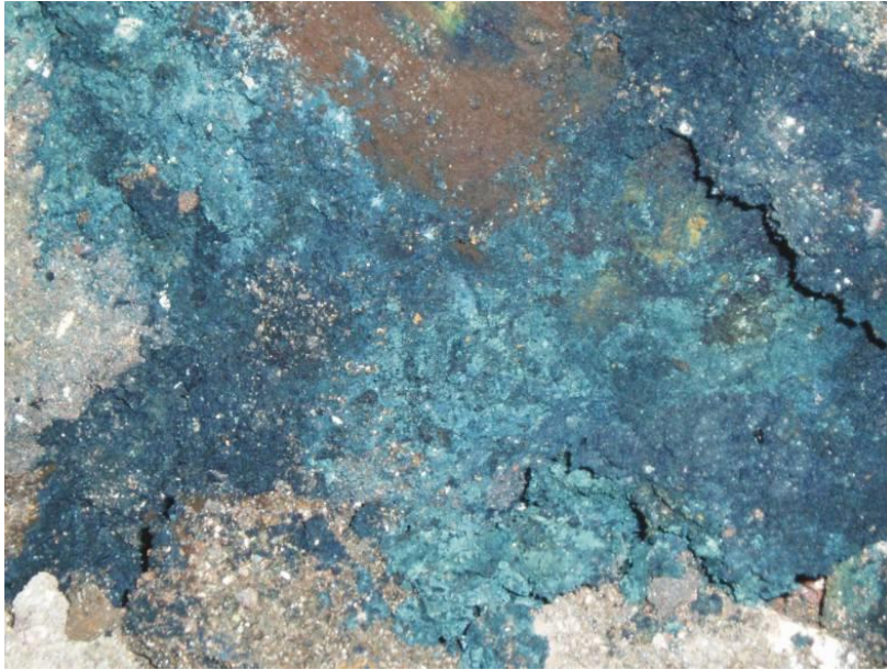
Bild 6. Cyanidförorening i mark (berlinerblått) (Foto: Mårten Osanius).
