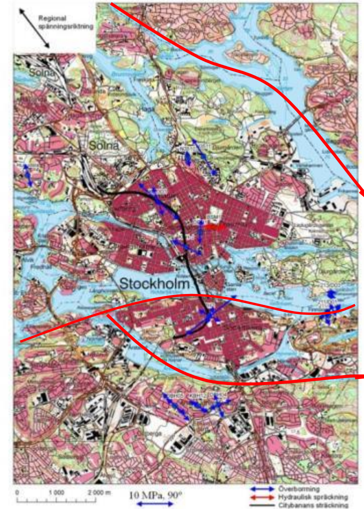
Figur 11 Riktning och storlek på medelvärden på största horisontalspänning per mätnivå för uppmätta spänningar i Stockholmsområdet. Även regional spänningsriktning samt Citybanans sträckning är markerade i figuren.
