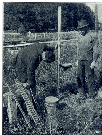
Fig. 11. Sondborrens sjunkningsdjup för 15 kg belastning avläses. (Klämman är av annan typ än den här föreskrivna).
