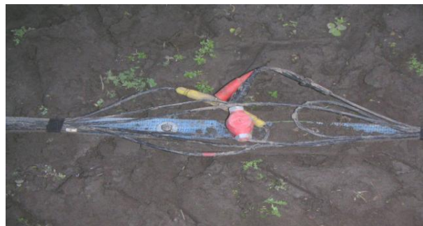
Figur 4 Geofonerna monterade på stålplattor, sk landstreamer, dragen av mc. Till höger detalj på geofon på stålplatta.
