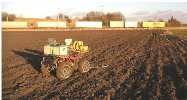
Figur 4 Geofonerna monterade på stålplattor, sk landstreamer, dragen av mc. Till höger detalj på geofon på stålplatta.
