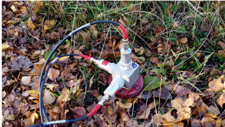
Figur 4. Tri-axiell geofon på platta som förankrades i marken.
