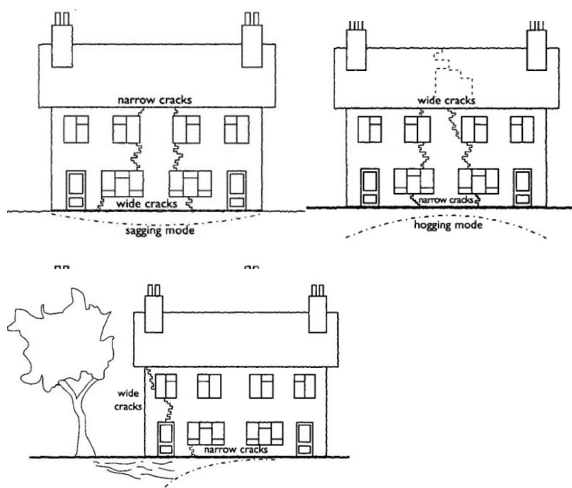
Figur 10 Sprickor vid olika sättningsformer. Ur Karlsrud (2015)
