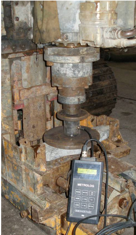
Figur 5: Uppställning för kalibrering av tryckkraft
