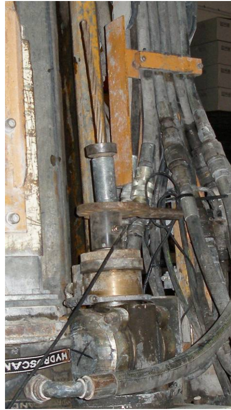
Figur 6: Uppställning för kalibrering av dragkraft
