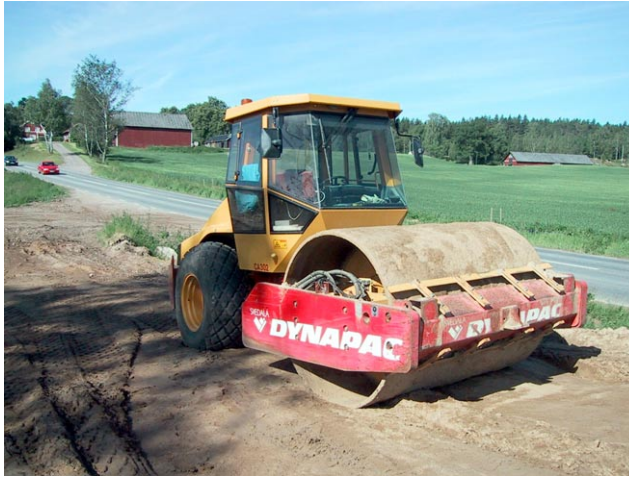
Figur 3. Vibrationsvält Dynapac 302D, linjelast 38 kN/m, använd vid undersökningarna i Boxholm och Karlskrona.
