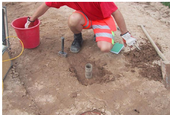
Figur 5a. Provtagningscylinder för upptagning av prover för vattenkvotsbestämningar.
