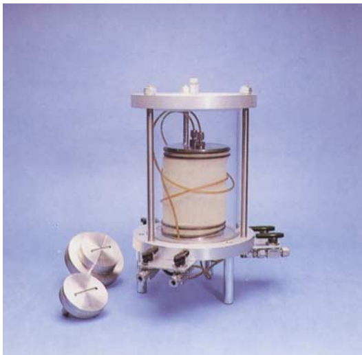
Fig. 14. Exempel på permeabilitetscell och tillhörande reglerutrustning. Föremålen vid sidan av cellen är adaptrar för att kunna variera provdiametern.
