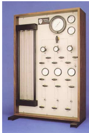
Fig. 14. Exempel på permeabilitetscell och tillhörande reglerutrustning. Föremålen vid sidan av cellen är adaptrar för att kunna variera provdiametern.
