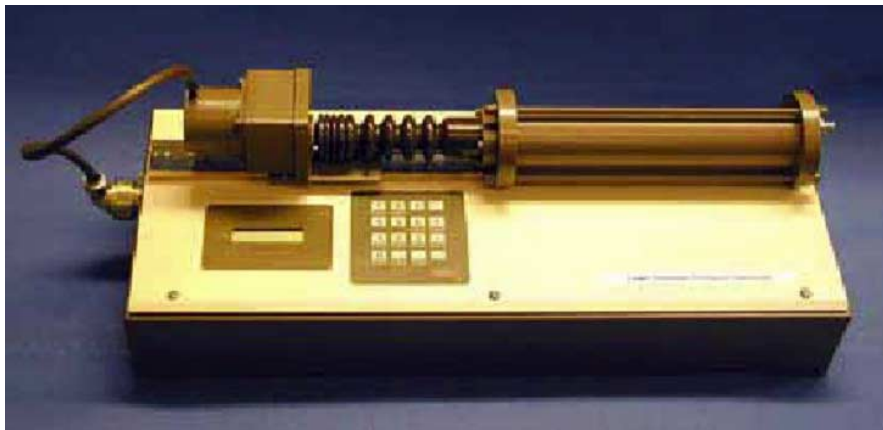
Fig. 12. Exempel på programmerbar tryck-volymkontroll.
