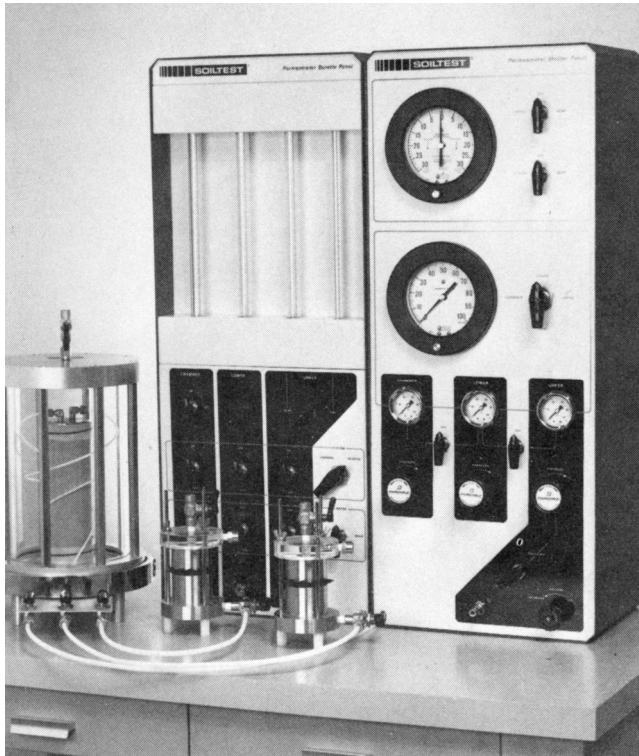
Fig. 16. Exempel på permeabilitetscell med cylindrar för uppsamling av utströmat porvatten som delar i trycksystemet.
