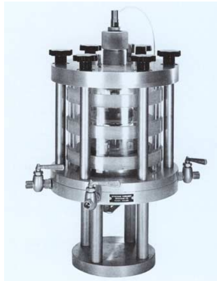
Fig. 11. Exempel på utrustningar för ödometerförsök med kontinuerlig kompression i celler där mottryck kan appliceras i porvattnet.
