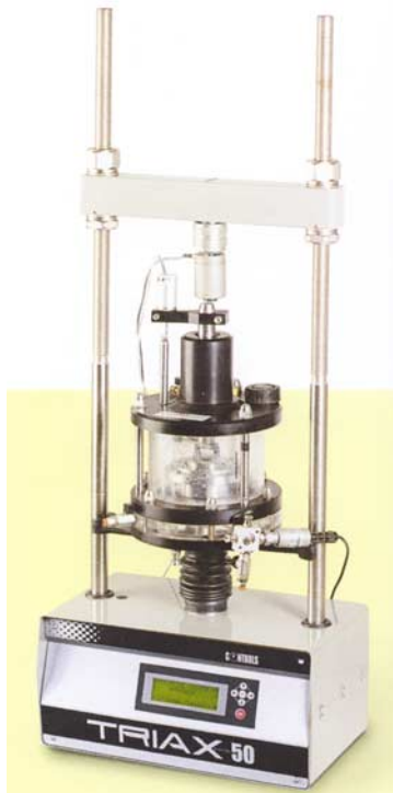
Fig. 11. Exempel på utrustningar för ödometerförsök med kontinuerlig kompression i celler där mottryck kan appliceras i porvattnet.
