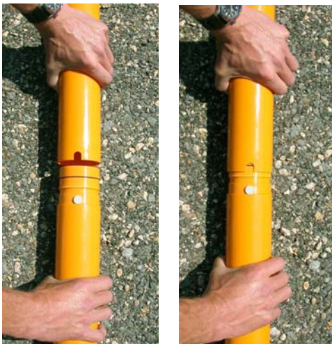
Figur 12.22 Skarvning med av inklinometerrör.
