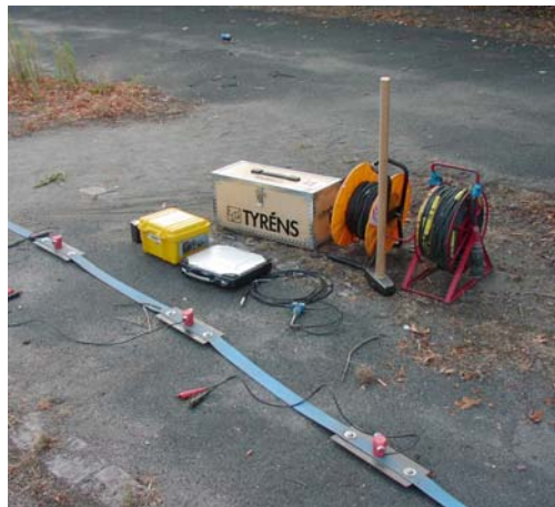
Figur 3.5 Seismikutrustning med landstreamer.
