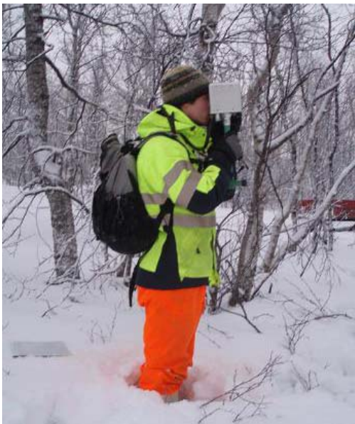
Figur 3.16 Fältmätning med VLF.
