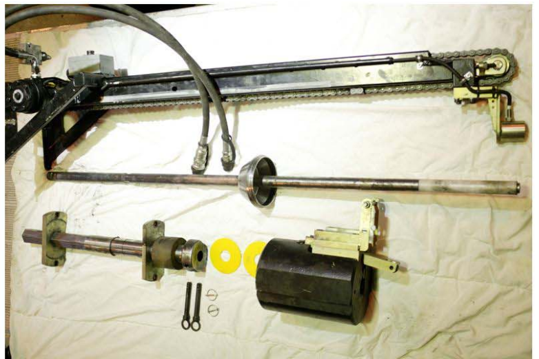
Figur 7.14 Detaljer av hejare och slagdyna med gummi-mellanlägg.
