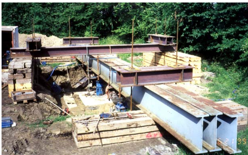
Figur 9.16 Exempel på mothållsanordning vid en serie stora plattbelastningsförsök.
