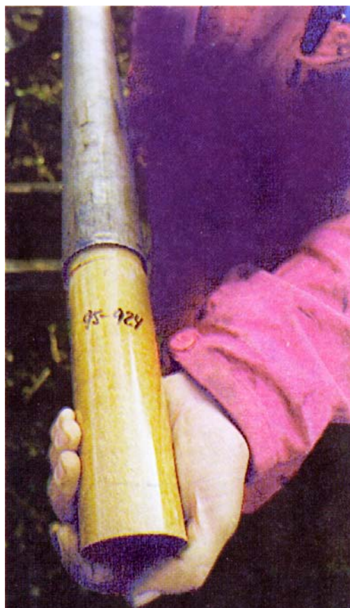
Figur 8.3 Provhylsorna placeras i provtagarröret med numren uppåt och i stigande nummerordning.
