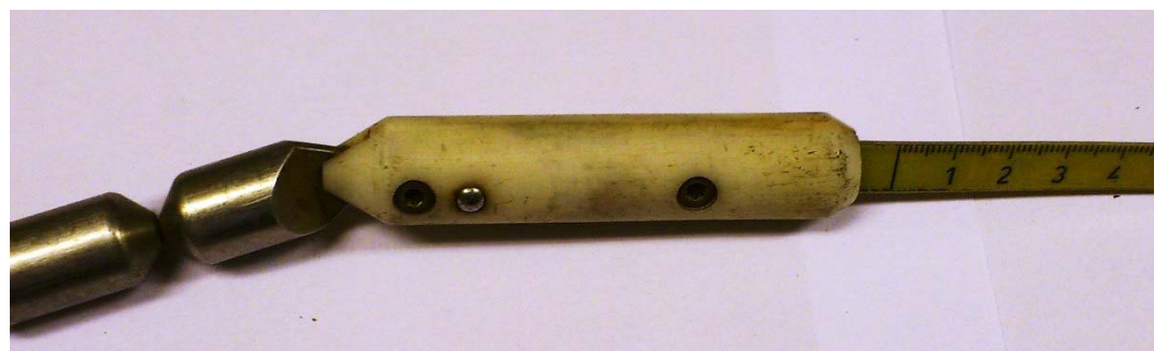
Figur 12.10 Mätdonet med måttband och tyngder.
