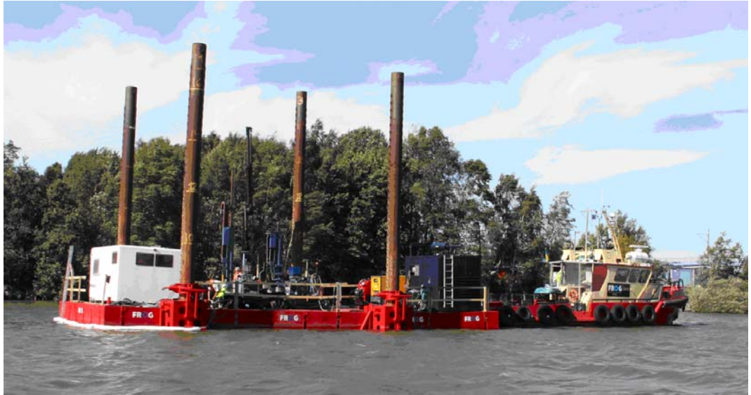
Figur 11.1 Jack up-flotte med arbetsbåt och två bandvagnar i Göta Älv.
