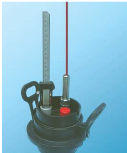
Figur 12.18 Mätning av extensometer med såväl ett mikrometerskjutmått som potentiometer för elektrisk mätning.
