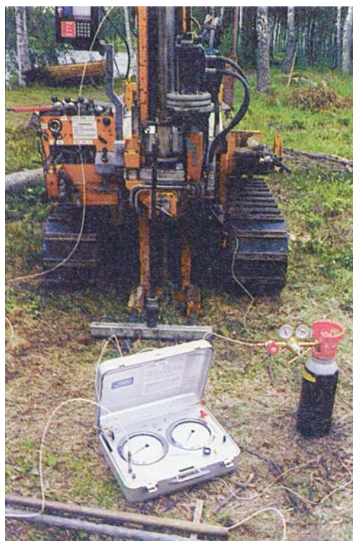
Figur 9.2 Dilatometer under nedtryckning med borrhandsvagn. Tryckslangen är förträd genom stängerna och ansluten till instrumentet och gastuben med sin reduccventil är inkopplad.
