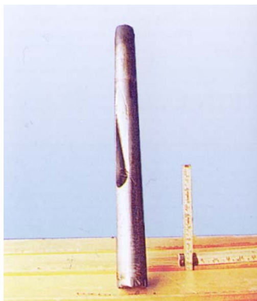
Figur 8.22 Genomströmningsprovtagare med 45 mm diameter.
