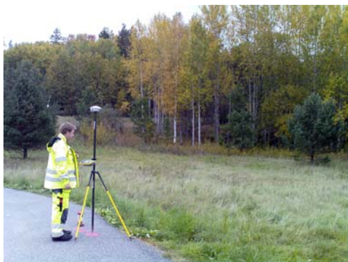
Figur 4.6 Mätning av piképunkt med GNSS.
