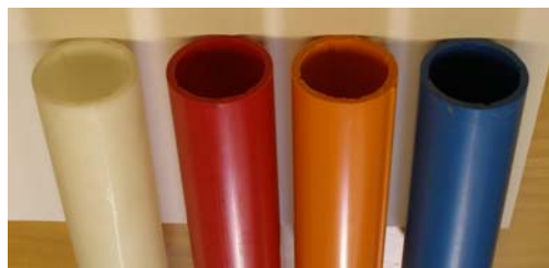
Figur 12.21 Olika fabrikat av spårade inklinometerrör.
