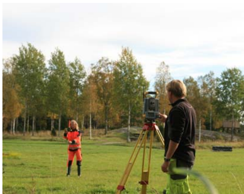
Figur 4.5 Mätning med totalstation.
