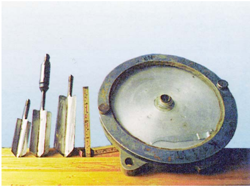
Figur 9.11 Vinginstrument för registrering av vridmoment som funktion av rotation på vaxat papper samt vingdon till utrustning utan skyddsrör och skyddskåpa. På den mellersta vingen ses en glappkoppling monterad.
