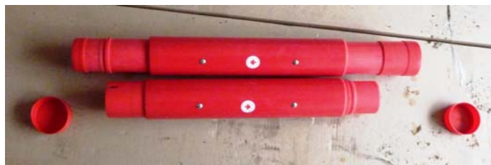
Figur 12.23 Exempel på teleskopskarv. Överst utdragen som vid installation och underst helt hoptryckt.
