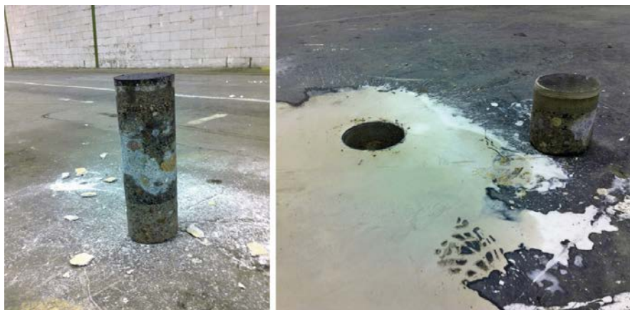
Figur 15 Provtagning av borrhörnar samt borrhörna vid borrhål med spolvatten (Geosigma)
