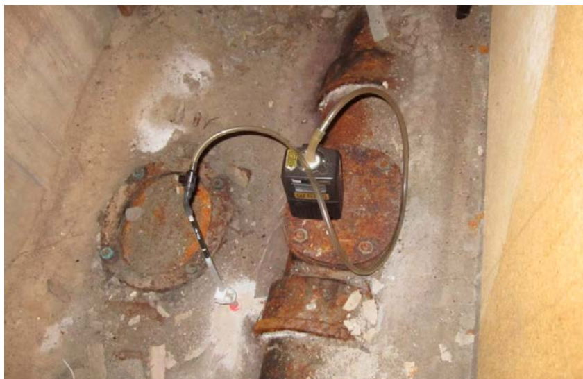
Figur 23 Porgasprovtagning genom bottenplatta med adsorbentrör (ÅF Infrastructure)
