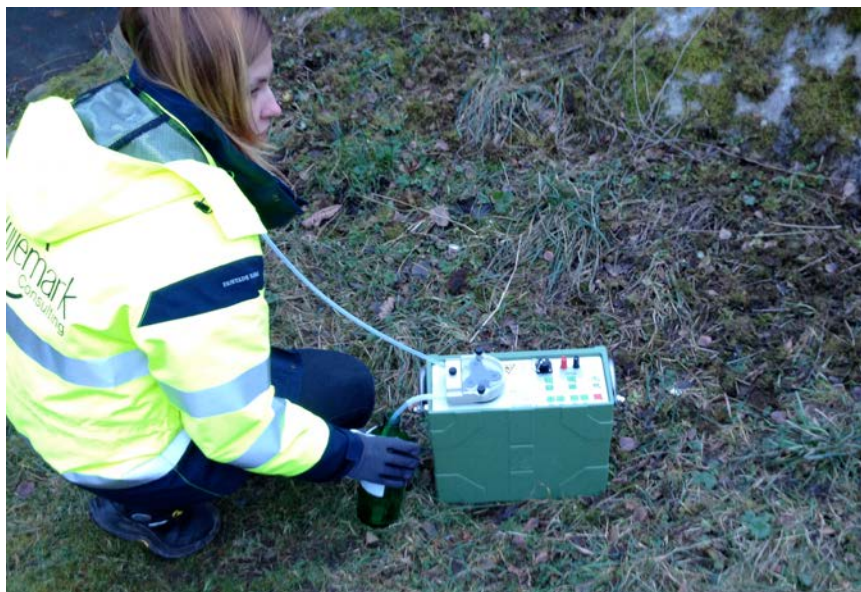
Figur 18 Provtagning med peristaltisk pump (Liljemark Consulting)
