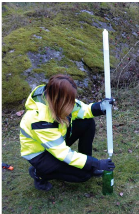
Figur 17 Överföring av grundvatten från Bailer till provtagningskärl (Liljemark Consulting)
