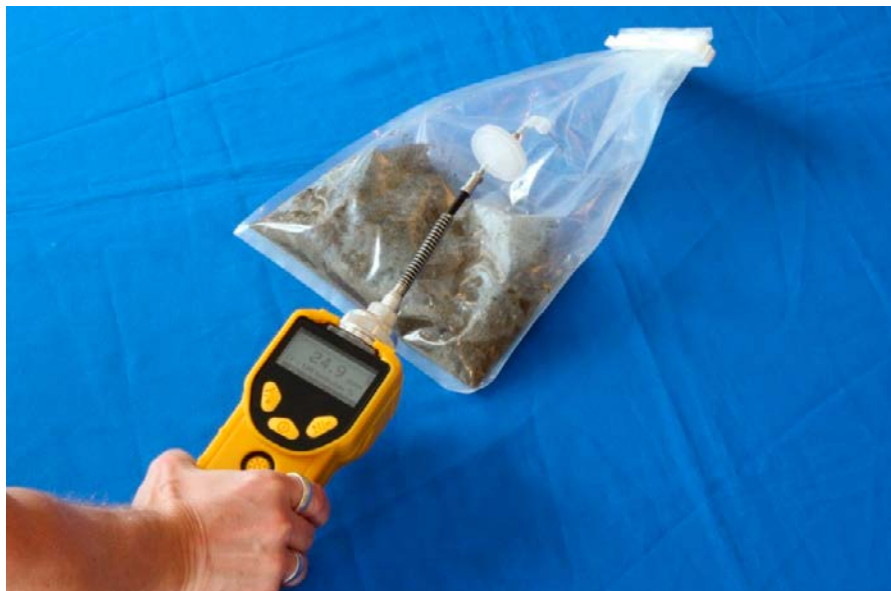
Figur 25 PID-analys på headspacegas ovanför ett jordprov (Scantec Nordic)
