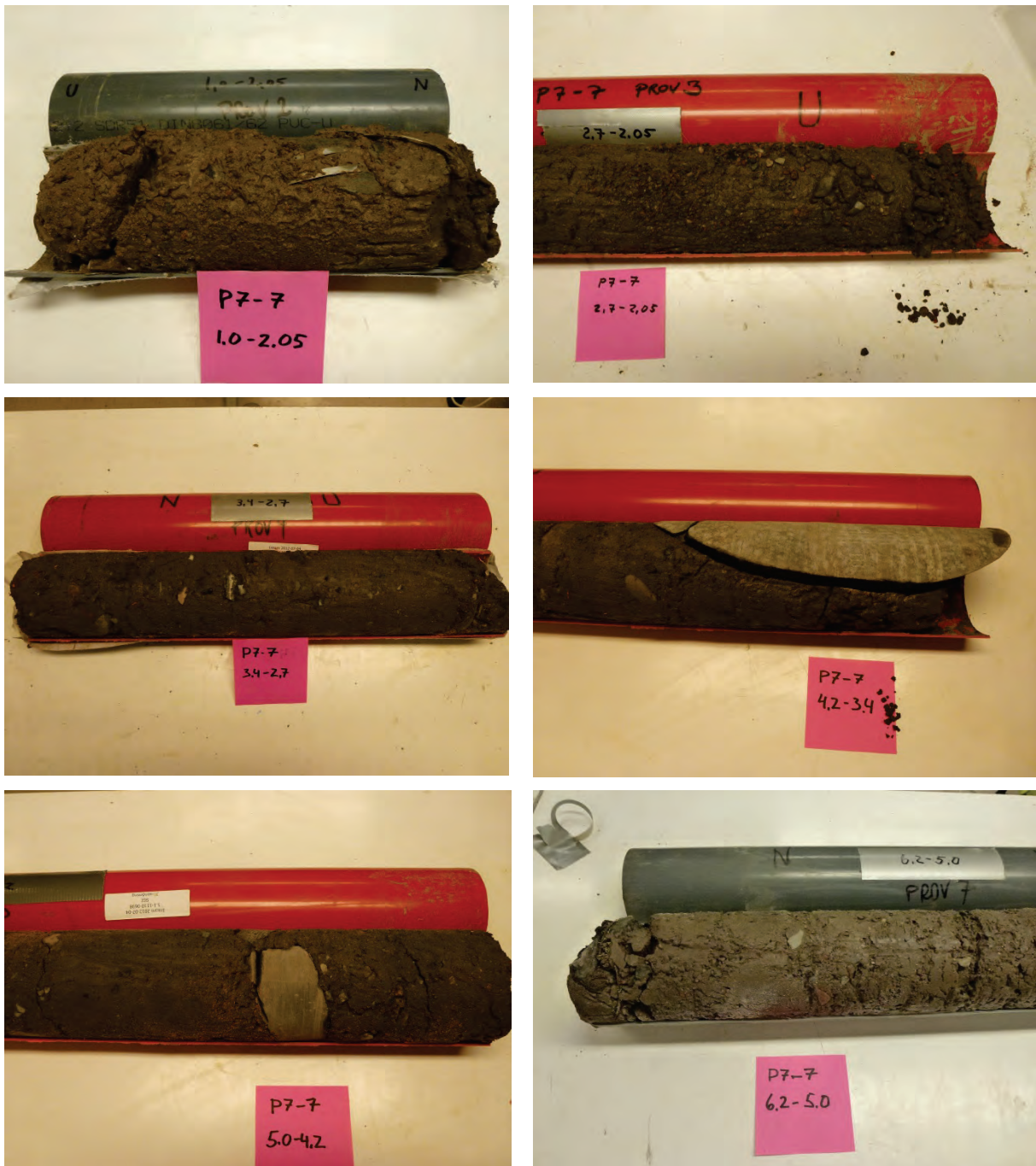
Figur 5-27: Jordprov tagna med Geobor-S på olika djup i punkt P7-7 (aktuellt djup angivet på rosa lapp i bilden).
