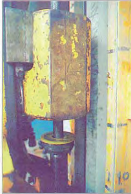
Fig 7:12 Detalj av hejare och slagdyna. Notera mellanläggen på slagdynan.
