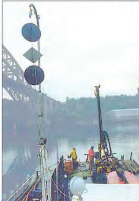
Fig 11:8 Signalfigur i dagsljus för borrhflotte i arbete med geoteknisk undersökning.
