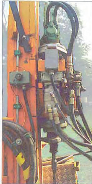
Fig 7:14 Borravn utrustad för slagsondering med slaghammare och slagstykke.
