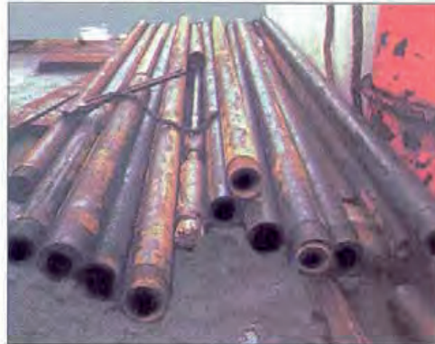
Fig 11:5 Foderrör skall alltid användas vid borrning från borrflotte.
