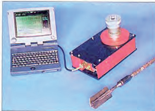
Fig 9:4 Vinginstrument typ Geotech med elektrisk mätning av moment och vridningsvinkel samt lagring och bearbetning av mätresultat i dator.
