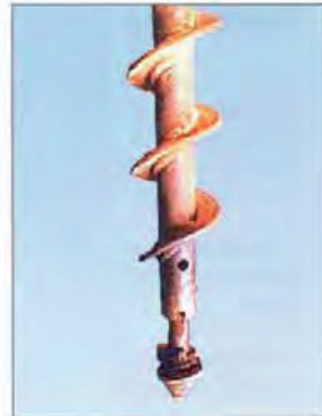
Fig 9:9 Augerskriv med öppningsbar spets för bentonutfyllning av pressometerhål.
