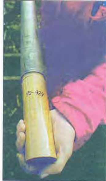
Fig 8:5 Provhylsorna placeras i kolvprovtagaren med numren uppåt och i stigande nummerordning uppifrån och ned.
