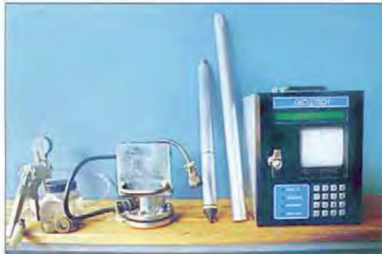
Fig 7:2 Utrustning för CPT-sondering (Geotech). Från vänster vakuumpump, behållare för vätskemättade filter, mikrofon för mottagning av mätsignaler från spetsen, sondspets, sändardel för sändning av mätvärden och datalogger för lagring av mätvärden.
