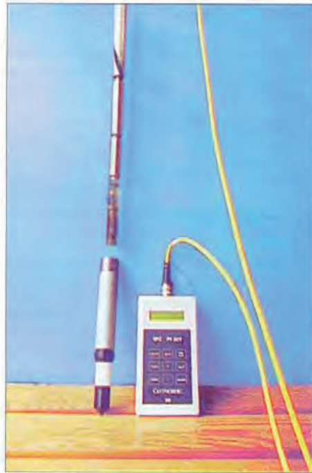
Fig 10:8 BAT-systemets delar: Portrycksspets, Mätkropp på förbindelsekabel och Mätinstrument.
