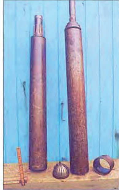
Fig 8:21 PG provtagare 90 mm. Till vänster för sänkdammare och till höger för toppdammare.
