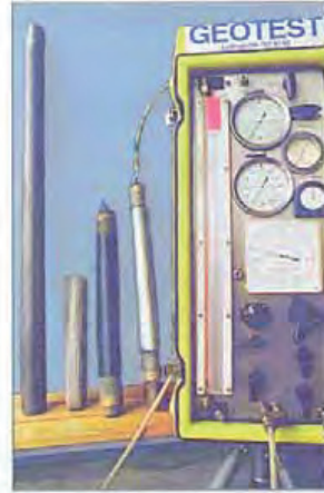
Fig 9:8 Pressometer typ Menard. Från vänster slitsrör för mätning i fast jord, stål-kordsskydd för mätning i skarpkantat material, mätkropp med gummimembran och en mätkropp innesluten i metallfolier. Till höger kontrollenheten.
