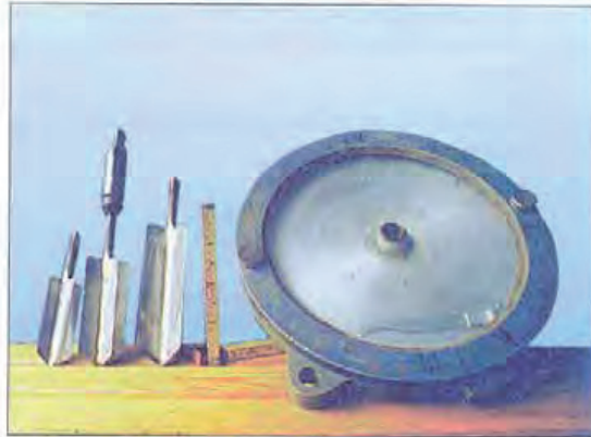
Fig 9:3 Vinginstrument typ Geotech med vingar i tre olika storlekar varav den mellersta med glappkoppling samt registreringsinstrument.
