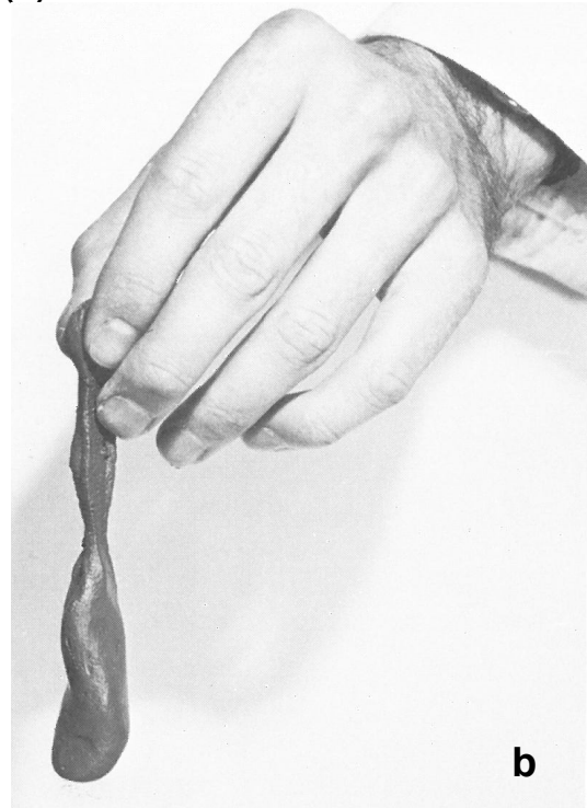
Figur 33. Skakförsök med en hand "slamsprov", på lerig silt, före skakning (a) och efter skakning (b).
