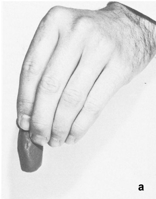
Figur 33. Skakförsök med en hand "slamsprov", på lerig silt, före skakning (a) och efter skakning (b).
