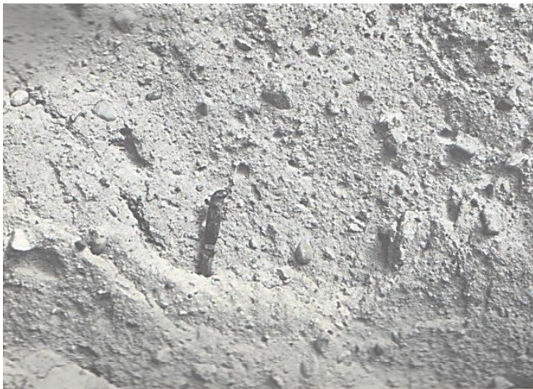
Figur 6. Bottenmorän av urbergsmaterial från Ytterhogdal (foto J Lundqvist, 1964). Typiskt för en bottenmorän är att den innehåller en regellös blandning av grova och fina korn. Kornen är oregelbundna till formen, kantiga och fast sammankittade.
