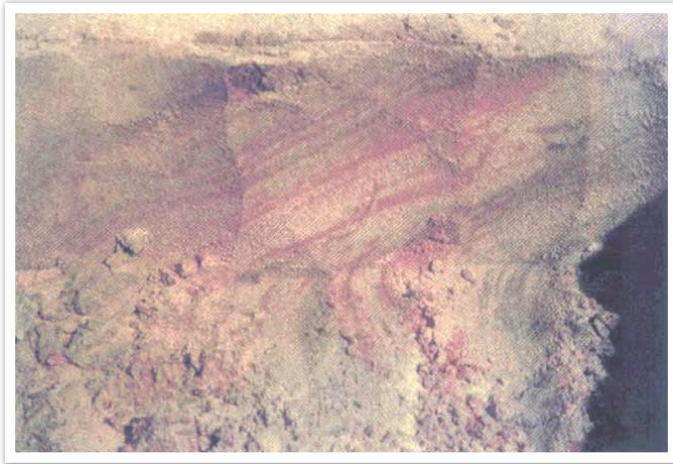
Figur 3 Försök där rödfärgat lösningsmedel (PCE) tillåts droppa ut över omättade sandskikt. Bildens vertikala snitt är ca 15 cm och visar hur föroeningen koncentrerats till enskilda skikt i sandformationen (ES&T Research, 1992).
