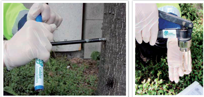
Figur 8 Provtagning av trädved i provtagningsvial med krymptång för förslutning (Foto: Golder Associates)
