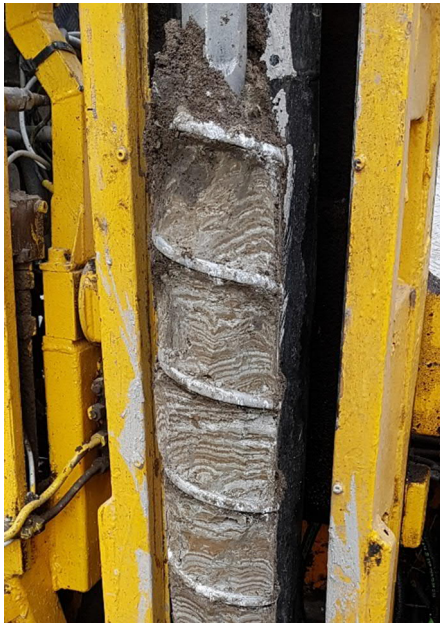
Figur 11. Relativt ostörd skruvborrskärna. Foto Annika Berntsson
