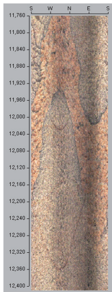
A) Hela borrhållsväggen med bergartsskiftningar
