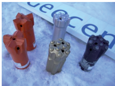
Figur 13 Olika typer av skärborr- och stiftborrkronor
