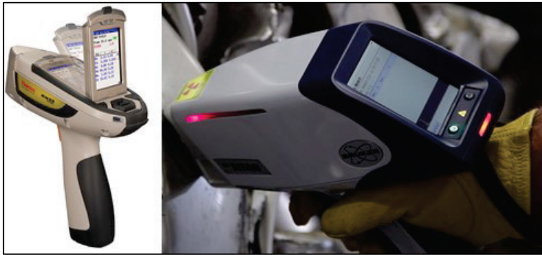
Figur 9. Exempel på XRF-instrument från Thermo Scientific och Bruker (S1 Titan).
