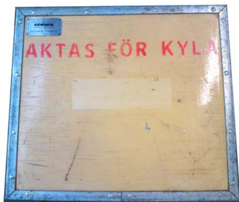
Figur 13. Princip för provtransport enligt SGFs laboratoriekommitté.
