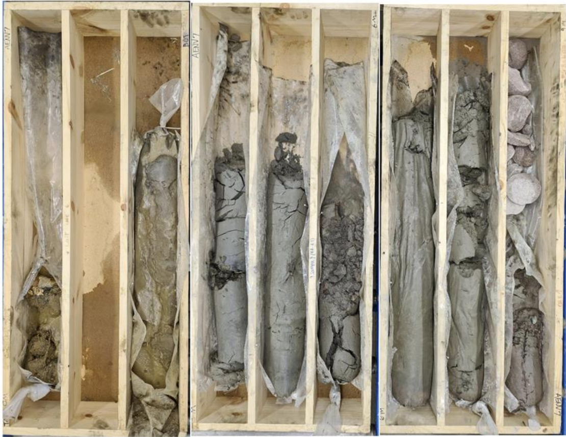
Figur 55 Kärnförluster vid provtagning i Aitik (Foto: Boliden).
