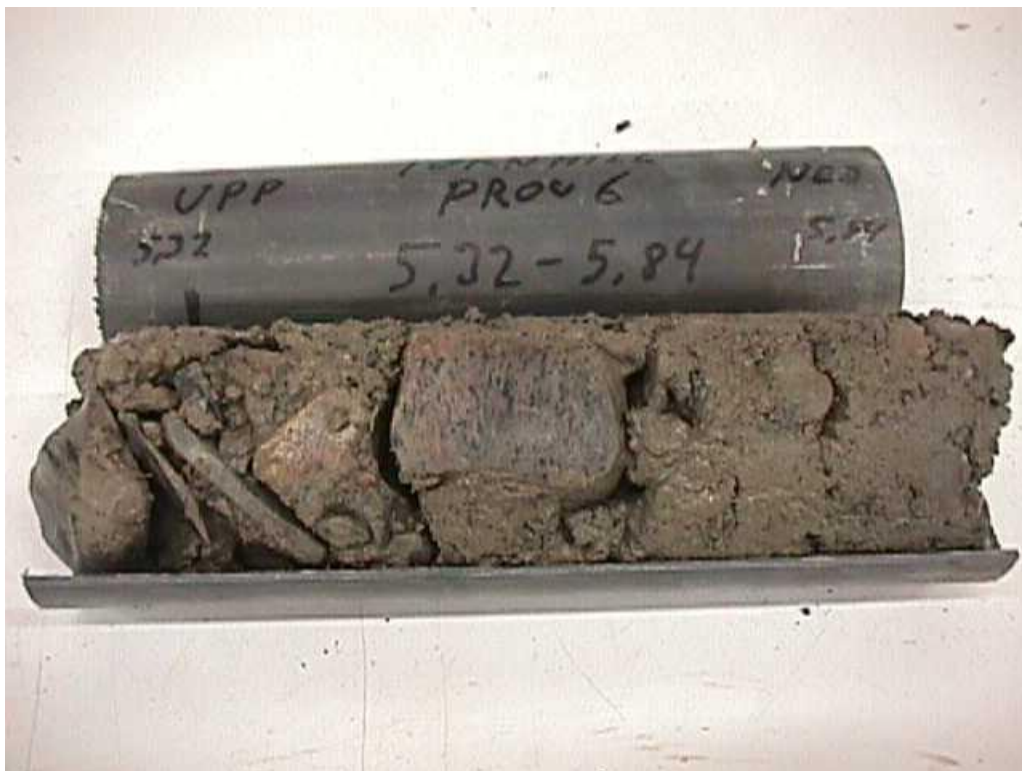
Figur 13 Exempel på prover av lermorän tagna med amerikanerrör (efter Larsson, 2001).
