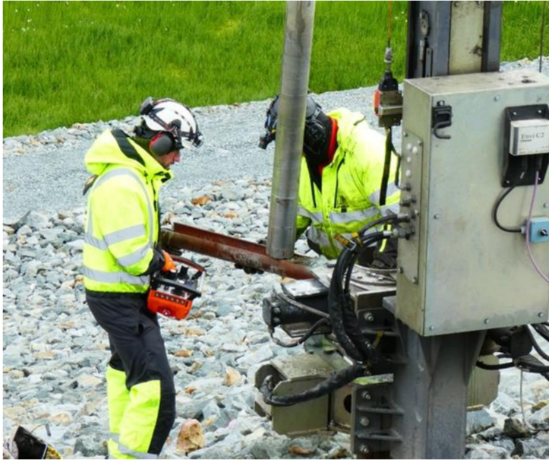
Figur 60 Överföring av provtagen jord från provtagaren till halvrör (Foto: B Dehlbom, SGI).
