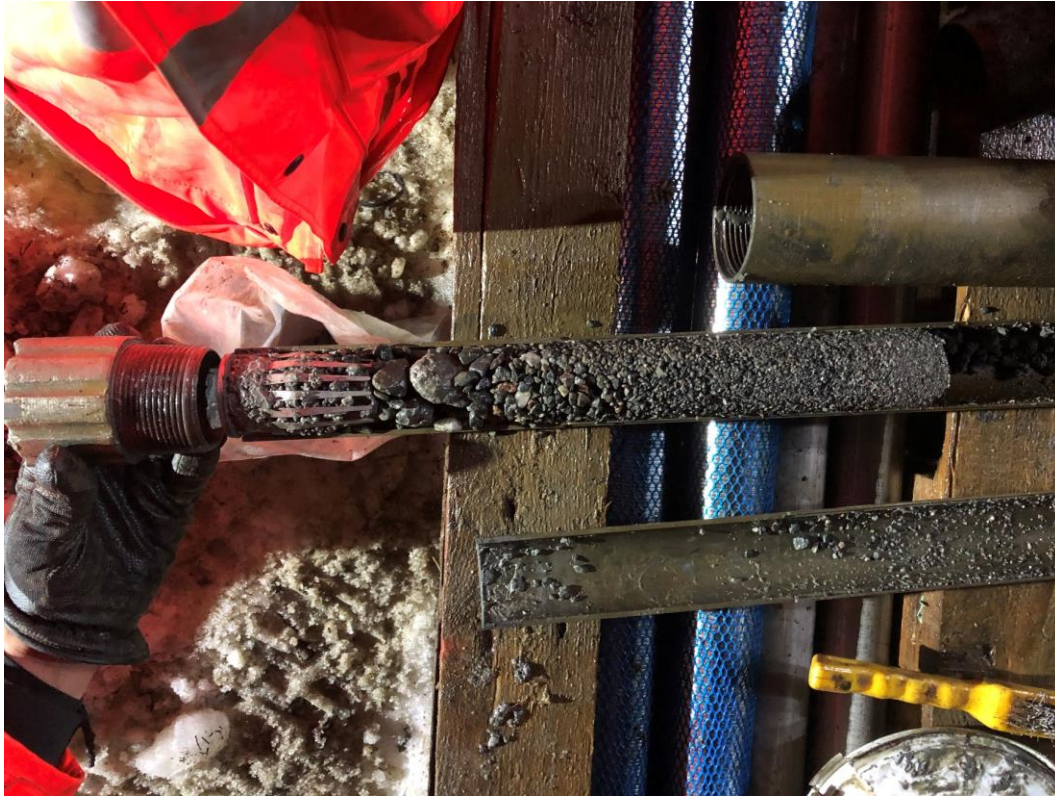
Figur 83 Jordprov upptaget med mullvad med yttre diameter om 44 mm i en jorddamm (Foto: T Andrén, Geofound).
