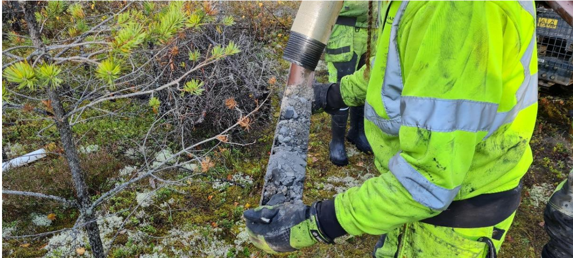
Figur 52 Torrt material från de översta 3 metrarna trycks ut med vibration och vattentryck till halvörret (Foto: K Lundström, SGI).
