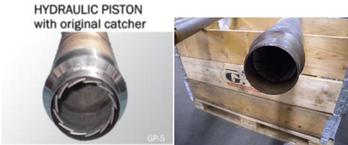
Figur 75 GP-S provtagarens nedre del med skär och slutaren (Foto t.v. ( https://www.kisojiban.com/ ), Foto t.h. M Andersson, SGI).
