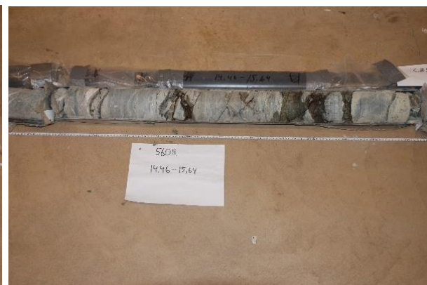
14,46 – 15,64 m Berg – fyllit med vittrade sprickor
