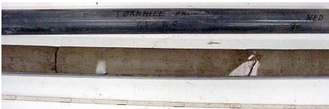
Figur 23 Borrkärna från 7,5 till 9,0 meters djup med sandig, siltig nordostlermorän med inslag av grus (Larsson, 2001).
