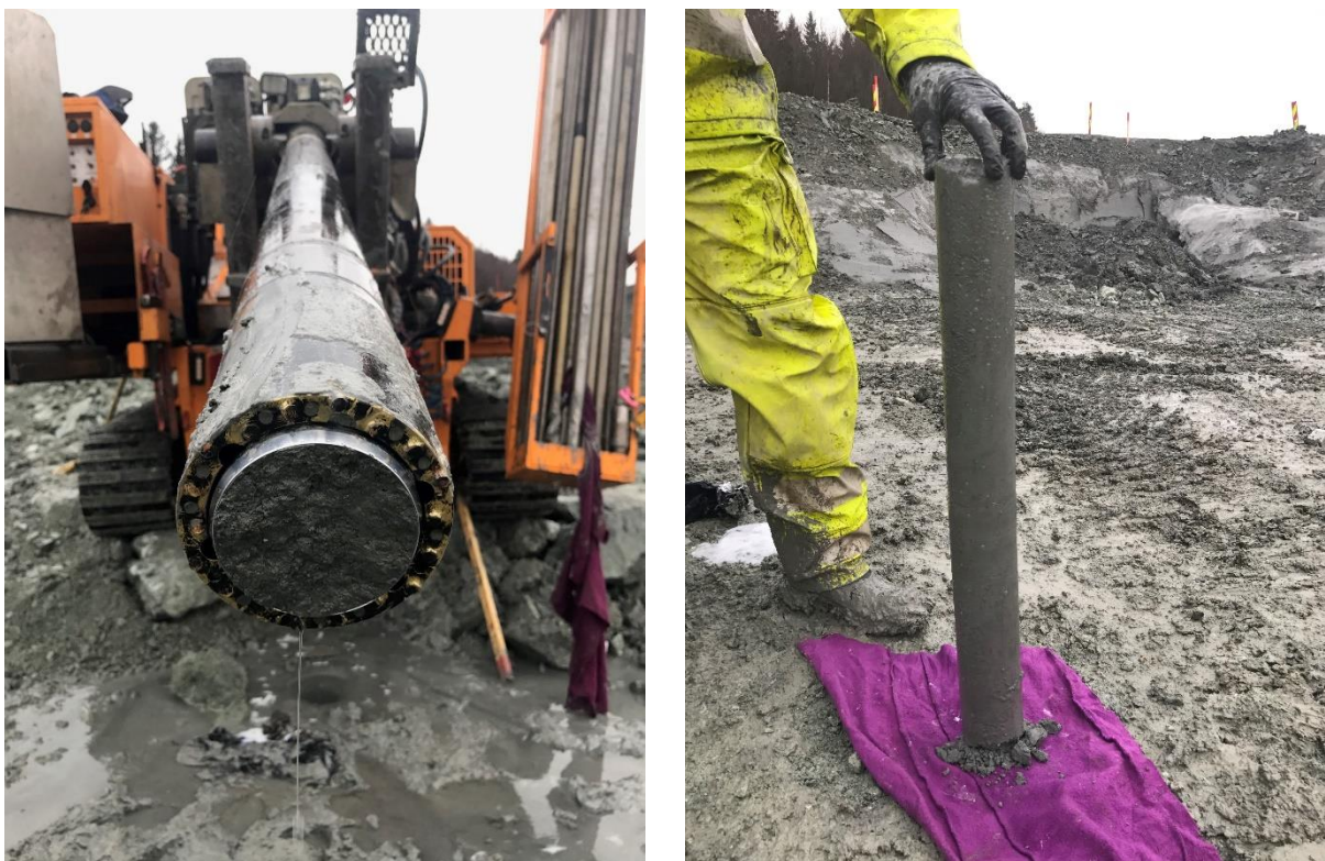
Figur 76 Provtagning med GP-Tr i KC-pelare, t.v. provtagarens nedre del direkt efter upptagning och t.h. visas upptaget prov uttryckt ur provtagningsröret (Foto: K Kåsin, NGI).
