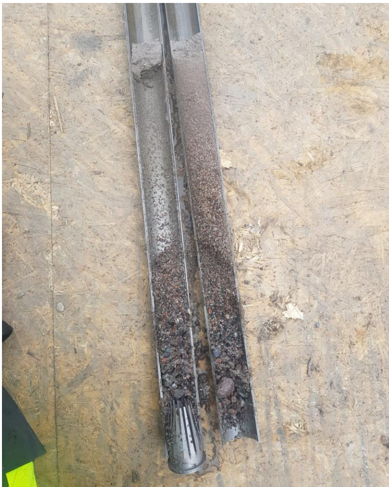
Figur 82 Jordprov upptaget med mullvad med yttre diameter om 44 mm på 23 m djup under markytan (Foto: A Torefeldt, AFRY).
