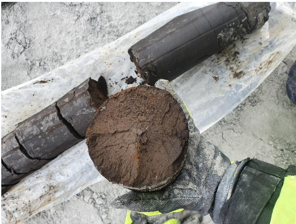
Figur 57 Provtagning av gyttja (Foto: Sweco).
