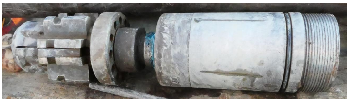
Figur 20 Koppling mellan innerrör (provtagare) och yttre foderrör (Foto: B Dehlbom, SGI).
