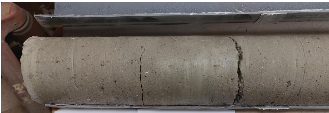
Figur 41 Kalkcementpelarprov från Sätinge (Foto: M Andersson, SGI).
