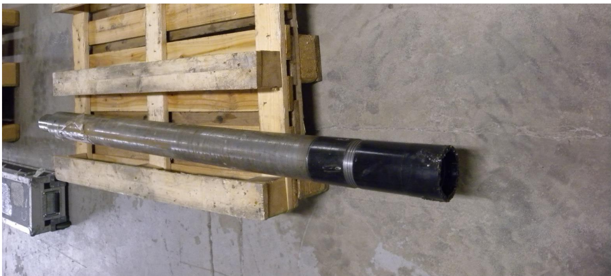
Figur 72 GP-Tr provtagaren hopmonterad (Foto: M Andersson, SGI).
