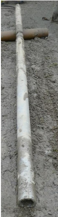
Figur 78 Provtagare typ mullvaden med yttre provdiameter cirka 75 mm och längd 2 m (provlängd 1,5 m) (Foto: B Dehlbom, SGI).
