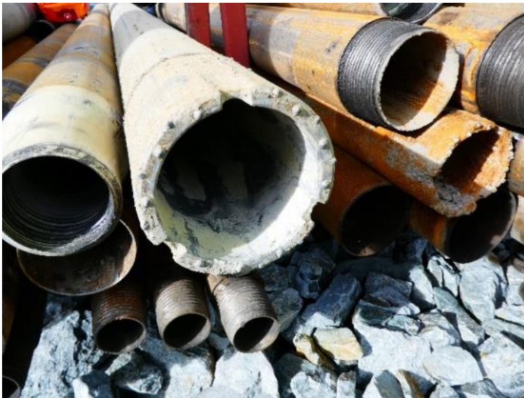
Figur 44 Foderrör med ytsatt kärnborkrona (Foto: B Dehlbom, SGI).
