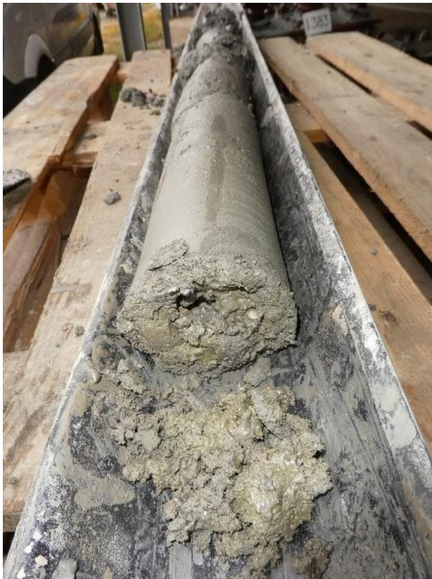
Figur 81 Foto på borrkärna med morän (sannolikt sandig, grusig siltmorän) (Foto: B Dehlbom, SGI).
