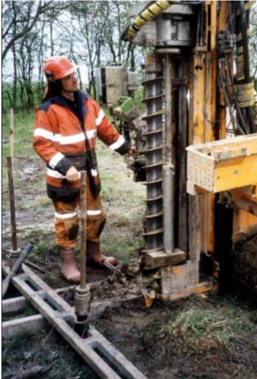
Figur 12 Provtagare typ amerikanerrör (till höger om den stora jordskruven) (SGF, 2013).
