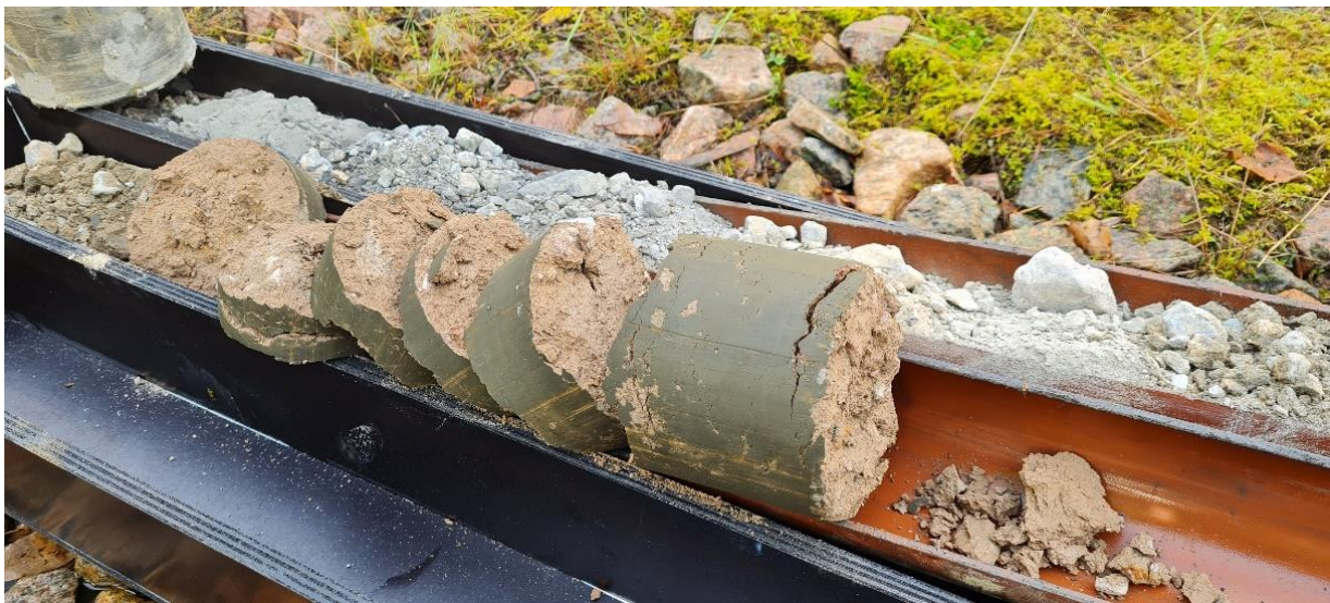
Figur 47 Jordprov vibreras ut ur provtagaren till halvrör (överst) och överförs därefter till en provlåda (nederst). Provtagning av anriknings-sand i Bolidens nedlagda gruva i Saxdalen (Foto: K Lundström, SGI).
