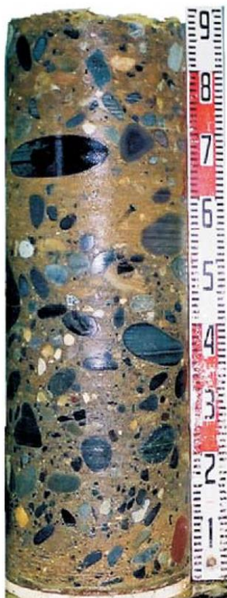
Figur 68 Jordprov (grus och finjord) upptaget med GP-R (diameter 300 mm) (efter www.kisojiban.com ).
