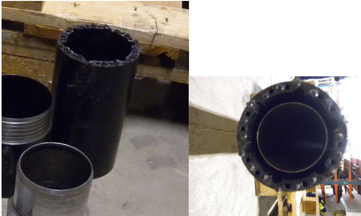
Figur 70 Borrkrona GP-Tr med bits av wolfram carbid (Foto: M Andersson, SGI).
