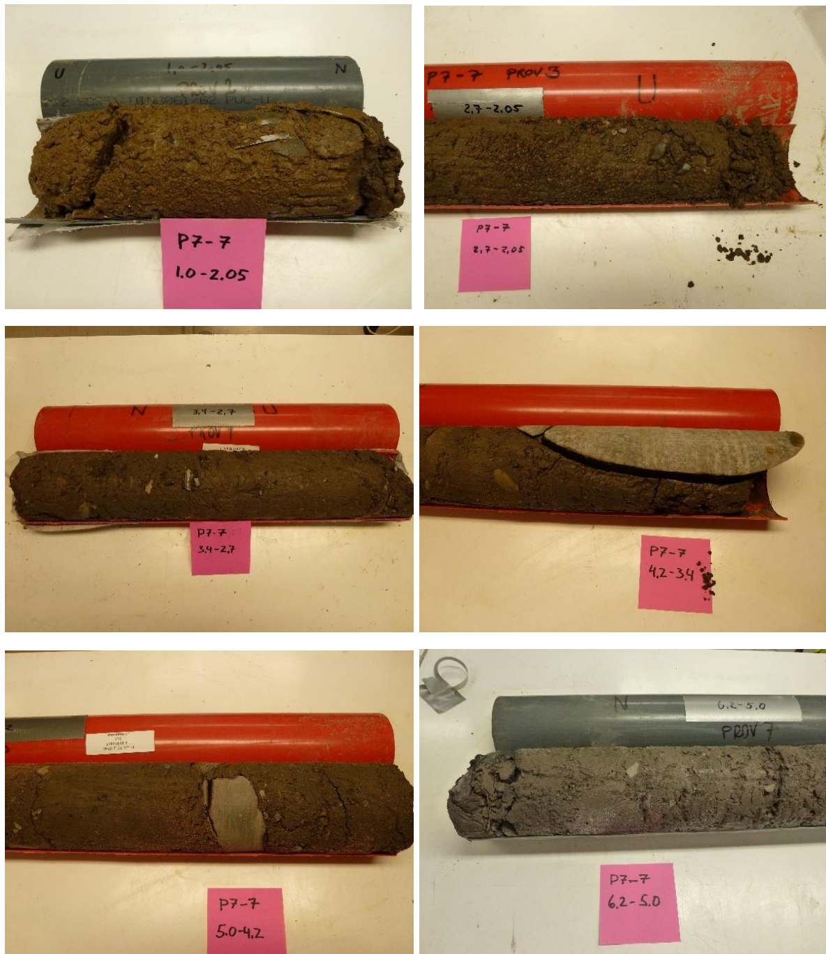
Figur 28 Jordprov tagna med S-Geobor på olika djup i punkt P7-7 (SGF, 2015).
