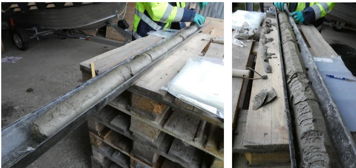
Figur 79 Foto på borrkärna med lerig silt/siltig lera av torrskorpekaraktär. Till vänster: Borrkärnan efter att ha tagits ur provtagaren. Till höger: borrkärna med avskrapad yta (Foto: B Dehlbom, SGI).
