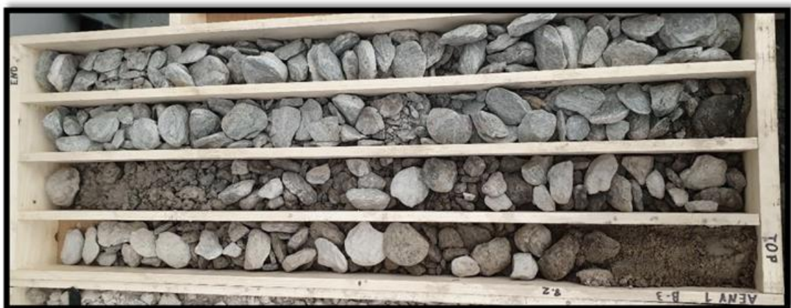
Figur 56 Prover på berg och grovkornigt material i Aitik (Foto: Boliden).
