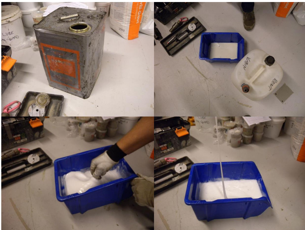
Figur 64 Illustration av blandningsprocessen och egenskaperna för gelen som används i GP-provtagarna. En liten del polymerlösning blandas med vatten (blandningsförhållande cirka 1:9) och vid omrörning bildas långa polymerkedjor som är smörjande och som omsluter provet vid provtagning (Foto: M Andersson, SGI).
