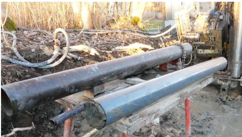
Figur 18 Helt provtagningsrör av plast till höger. Innerrör av stål (provtagare) till vänster (Foto: B Dehlbom, SGI).
