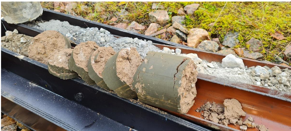
Figur 53 Jordprover i provlåda. Den övre delen av jordprofilen (längst bort i bild) var grovkornig och torr medan den längre ner i profilen (närmast kameran) var finkornigare och fuktigare (Foto: K Lundström, SGI).
