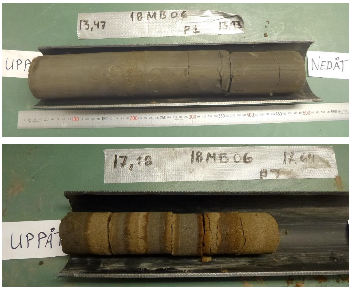
Figur 10 Exempel på siltprover tagna med öppen, tunnväggig rörprovtagare längs Ångermanälven (Foto: SGI).
