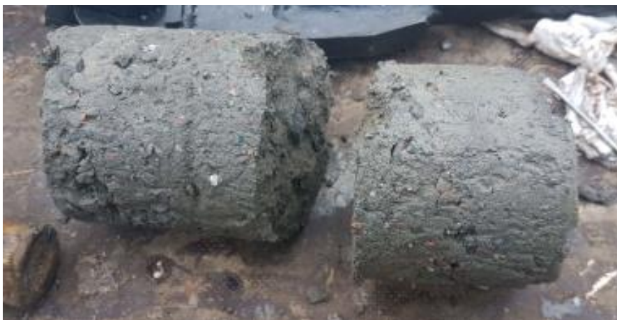
Figur 92 Bilden visar prov med diameter cirka 102 mm av bottenmorän upptaget i punkt 17S10459 med S-Geobor (Chapman med flera, 2019).
