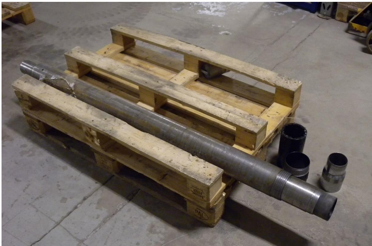
Figur 70 Borrkrona GP-Tr med bits av wolfram carbid (Foto: M Andersson, SGI).
