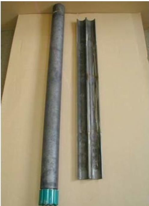
Figur 77 Provtagare typ mullvaden, med innerrör och yttre provdiameter 44 mm (efter SGF, 2013).
