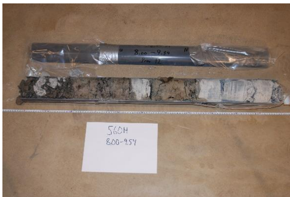
8,00 – 9,54 m Vittrad och ovittrad amfibolit
