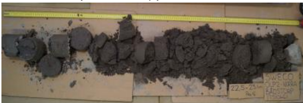
Undre bottenmorän med ett siltigt sandlager. Punkt 17S10461, djup 22,5-23,1 m.
