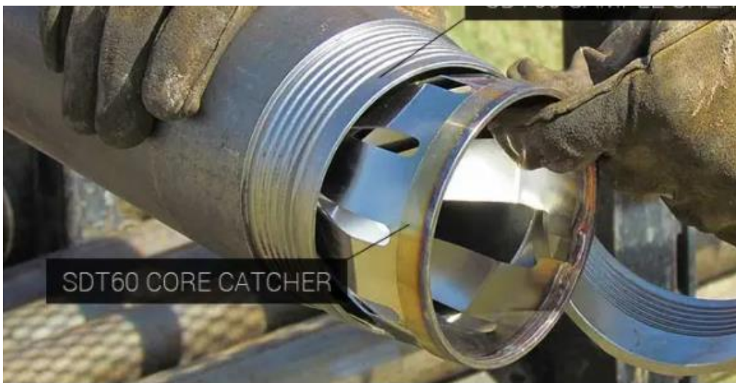
Figur 46 Slutare i plast i inre provtagningsrör av halvårsmodell överst (Foto: H Branzén, SGI) och nederst slutare med fingrar i metall (www.geoprobe.com).
