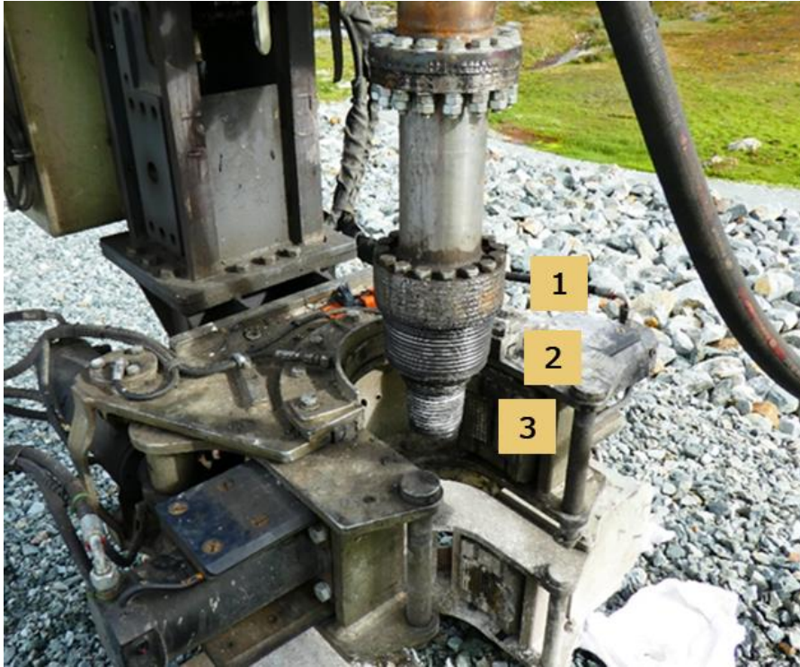
Figur 43 Borrstång försedd med olika gängor; (1) gänga för foderröret, (2) gänga för provtagaren och (3) gänga för drivningsröret. Gängorna är gängade åt olika håll (Foto: K Lundström, SGI).
