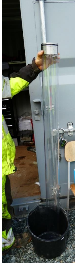
Figur 62 Inre provtagningsrör i plast med vakuumventil, avsedd för sonicborrning, diameter 100 mm (Foto: B Dehlbom, SGI).
