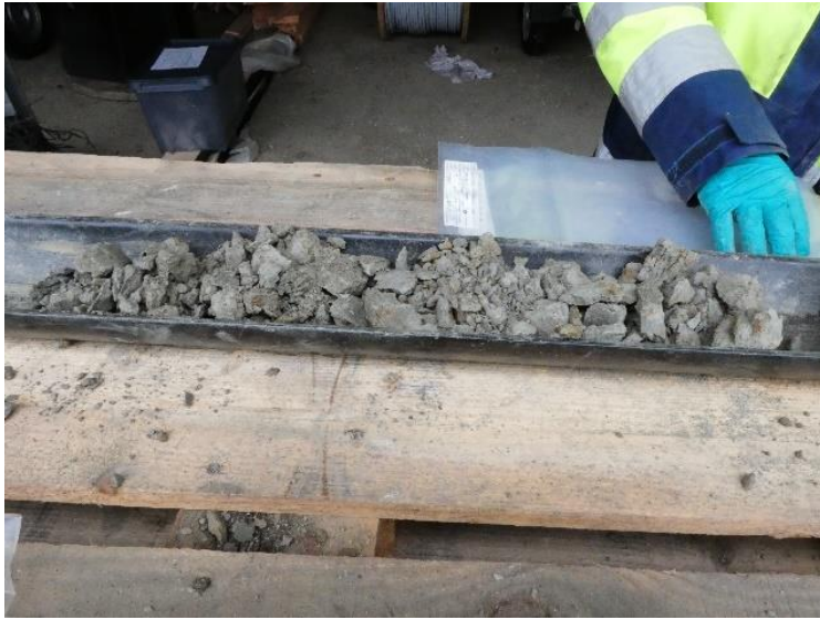
Figur 80 Foto på borrkärna med finsand/siltig finsand som inte hänger ihop (Foto: B Dehlbom, SGI).
