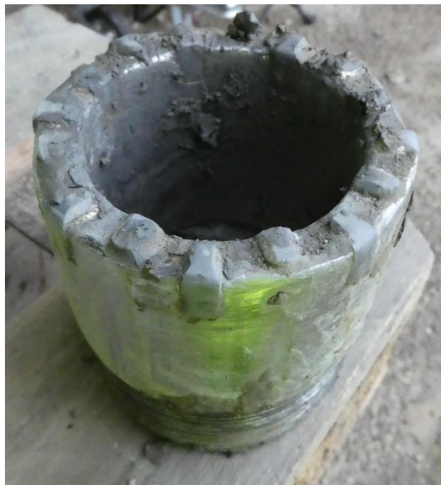
Figur 78 Provtagare typ mullvaden med yttre provdiameter cirka 75 mm och längd 2 m (provlängd 1,5 m) (Foto: B Dehlbom, SGI).
