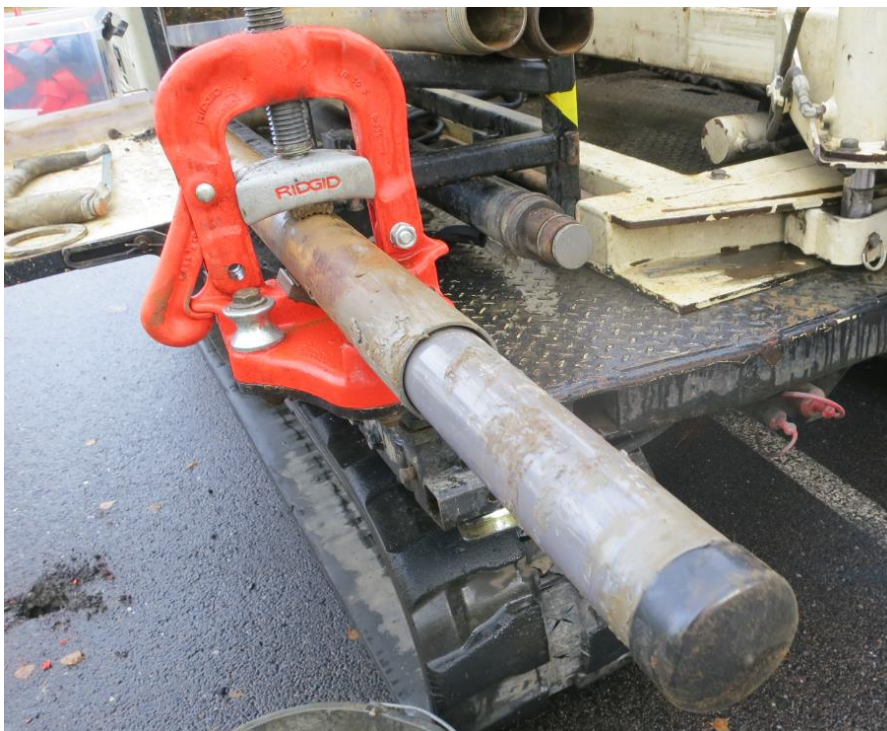
Figur 49 Inre provtagare försedd med plastlock (Foto: H Branzén, SGI).
