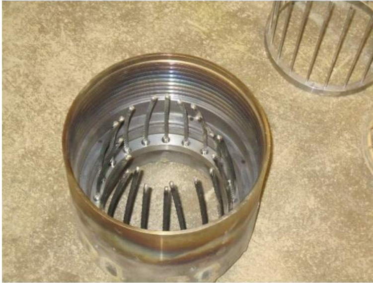
Figur 59 Slutarbleck framtaget för provtagning av stödfyllning i Messauredammen (efter Ekström med flera, 2018).
