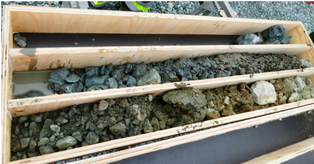
Figur 61 Spår av vattenspolning i övre delen (vänster i mittenlådan) av provtaget material. Vattenspolning hade startats då block påträffats i nedre delen av provtagningsnivån (Foto: B Dehlbom, SGI).
