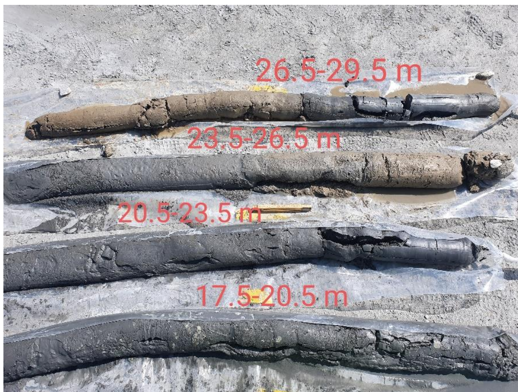
Figur 58 Provtagning av anrikningssand (Foto: Sweco).
