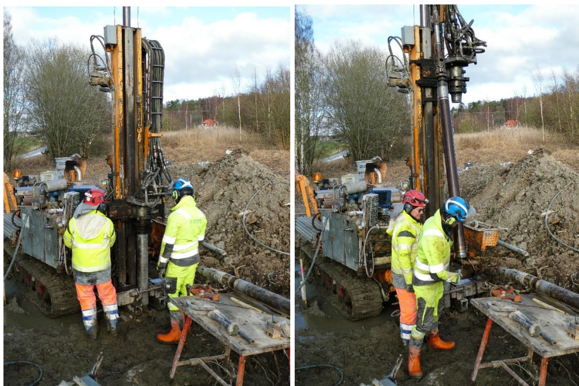
Figur 38 Provtagning med S-Geobor i Sätinge (Foto: B Dehlbom, SGI).
