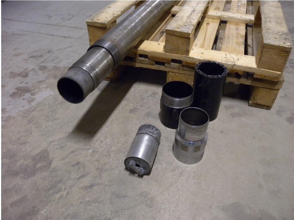
Figur 71 GP-Tr provtagare, Ytterrör, mellanrör och ett inre provtagningsrör. På nedre bilden syns även borrkrona, skär och rörlig kolv med kulbackventil (Foto: M Andersson, SGI).
