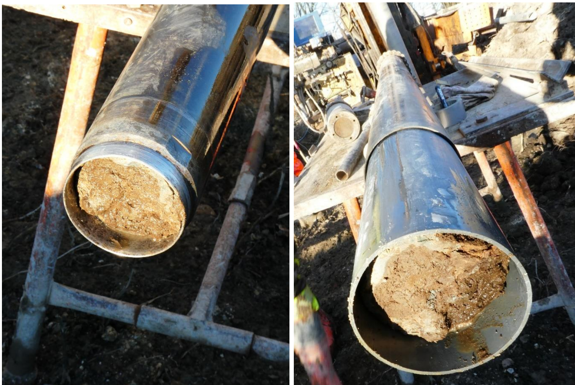
Figur 40 Provtagningsrör (Foto: B Dehlbom, SGI).
