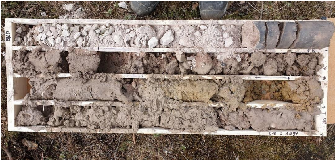
Figur 54 Jordprover vid Aitik. Övre delen av bilden - problem med provlådor som har mindre diameter jämfört med provtagaren (Foto: Boliden).
