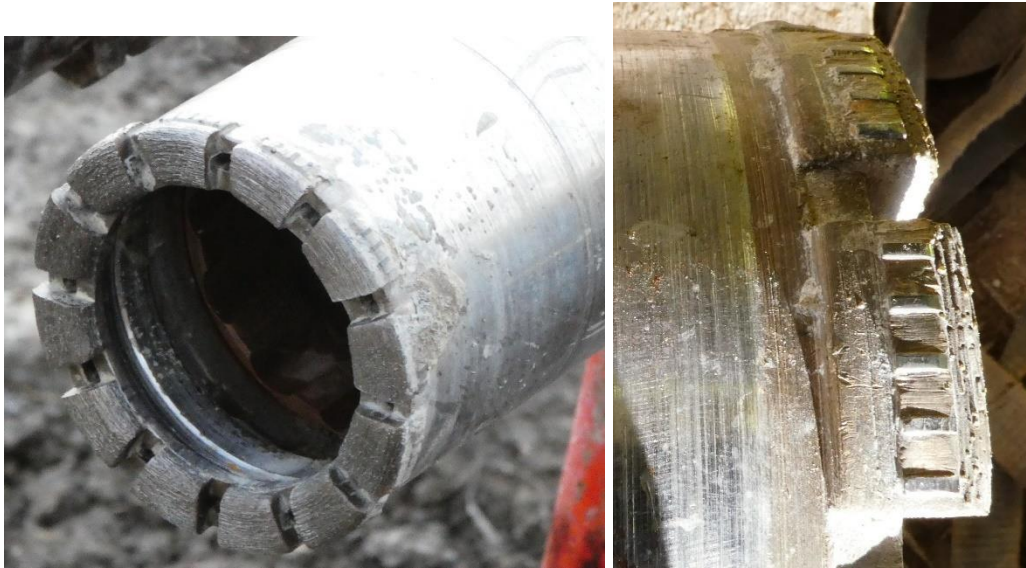
Figur 39 Borrkrona vid provtagning av kalkcementpelare i Sätinge (Foto: B Dehlbom, SGI).
