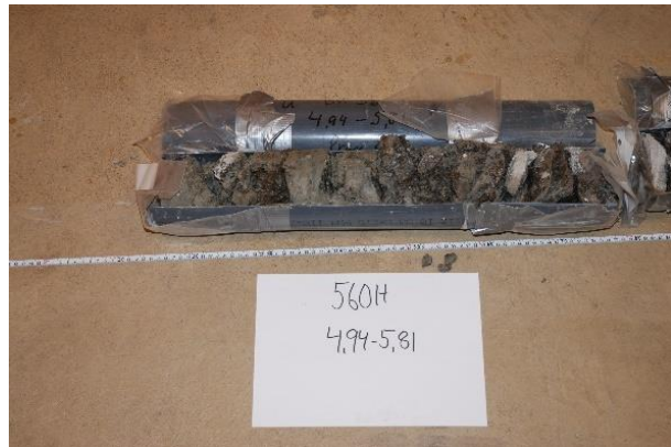
4,94 – 5,81 m Kraftig sprucken och vittrad fyllit
