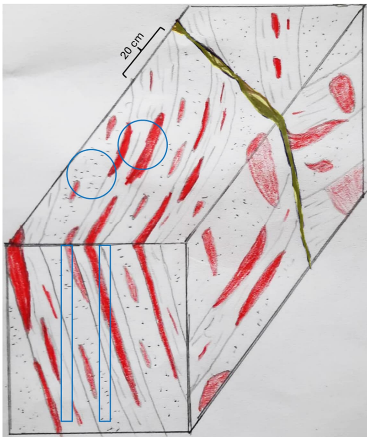
Figur 1. Schematisk bild av sedimentär gnejs i Stockholm (ritad av Paul Evins, WSP). Lagringen är brant och sulfid/arseniklinser (röda) ligger vanligtvis parallellt med och i lager och är mer utsträckta i vertikalled än horisontelled. Skjuvzoner och sprickor (gula) kan innehålla ännu högre sulfidhalt än linserna. Representativ provtagning av bergmassan försvåras av denna variation i sulfid- och arsenikfördelningen. Svavelhalten i enskilda ytprover (blå ringar) kan variera kraftigt inom korta avstånd. Borrhålsprover (blå rektanglar) kan visa samma variation, men påverkas också av linsernas utsträckning i vertikalled.
