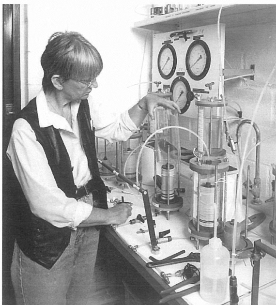
Figur 5:13. Bestämning av hydraulisk konduktivitet i laboratorium.
