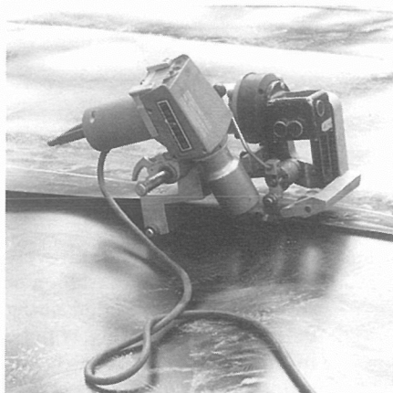
Figur 5:4. Varmluftsvets. Ett munstycke blåser varmluft mellan överlappen som smälter geomembranet. Dubbla eller enkla tryckrullar driver maskinen framåt och pressar samman de båda skikten till en homogen fog.
