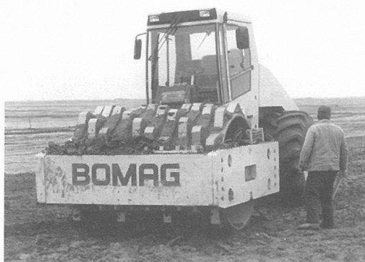
Figur 5:15. Padfotsvält, mest lämpad för packning av lerjordarter.
