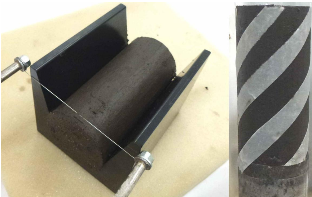
Figur 16 Provprepareringsvågga som används för att kapa provet till rätt mått och planparallella ändytor. Till höger visas ett prov med filterpappersremсор applicerade.
